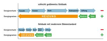
Je weniger Wärme ein Gebäude dank effizienter Wärmedämmung verliert, desto weniger Heizenergie muss ihm zugeführt werden
