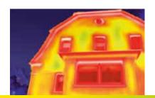
Die Wärmekamera bringt es ans Licht: Durch Fenster, die nicht dem neuesten Standard entsprechen, entweicht kostbare Heizungswärme.
